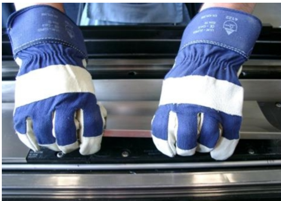
图 5-28 分段式盖板的拆卸
